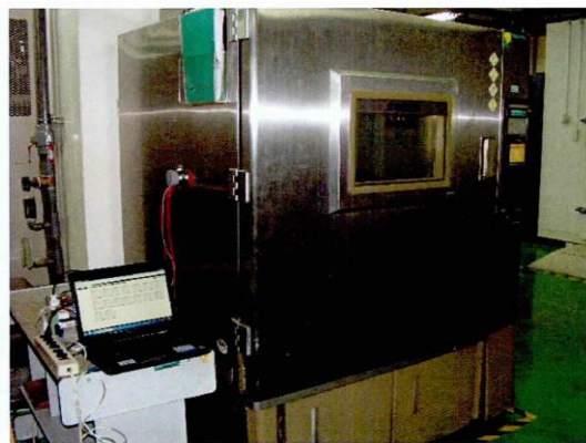
圖 6：溫度操作試驗 (外)
